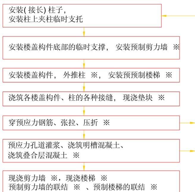
图 3.6.1 每一楼层主体结构的主要施工步骤
